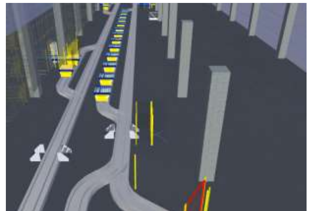
Circuit de navettes pour alimentation du stockage dans bâtiment Quais au R+1
