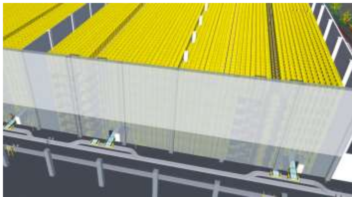
Vue vers les cellules de stockage en arrière plan et la boucle de navette d'alimentation au R+1 des quais au 1 er plan
